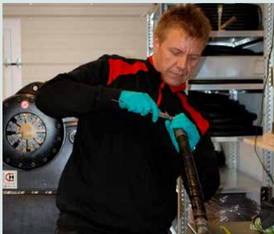
Bjørn Steinar Østensen er spesialisten på hydraulik. Her monterer han en kobling på en spesialslange.
